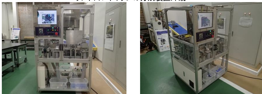
ペットボトルキャップの分別装置外観
