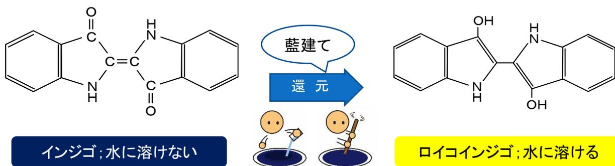
藍建てによる還元によって生成されたロイコインジゴを含んだ液体は黄色で、ロイコインジゴに還元されていないインジゴの藍色と混ざることによって、還元状態の藍染め液は黄緑色または緑色をしています。この状態になると布や糸を染める事ができます。ロイコインジゴが含まれている藍染め液に布や糸等を浸け、ロイコインジゴを繊維の中に吸収させます。藍染め液から引き揚げ、空気中の酸素に触れる事でロイコインジゴが酸化され、インジゴに戻ることで、色が黄緑色（もしくは緑色）から藍色へと変化します。不溶性のインジゴに変化したことで、藍色が繊維に定着します。
