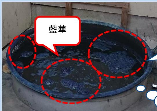
▲液の表面が藍色になっているのは、ロイコインジゴが空気に触れて酸化されてインジゴになったため。
