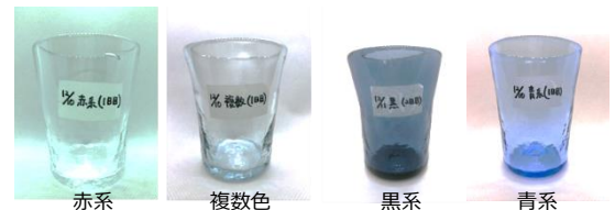
各色・粒子別に試作品を作成し発色状態を確認
