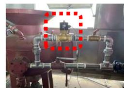
◀ 既設ブラストパットを改造し、配管および電磁バルブを取付
