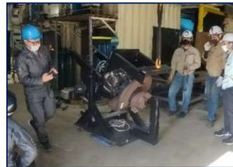
実験用架台での傾け動作確認
